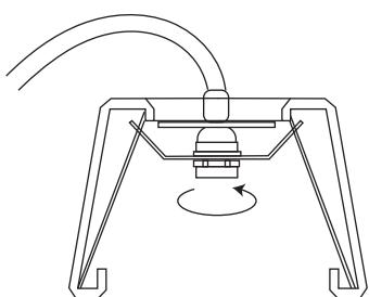
②スタンド本体のソケットに付属している取付用リングを回して外してください。
