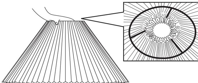
④ゆっくりと手を離せば、シェードの折り返し部分がフレームのリングに引っ掛かり固定されます。
