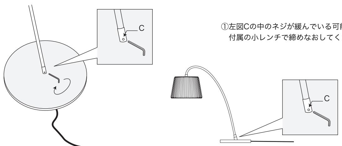
①左図Cの中のネジが緩んでいる可能性があるので、付属の小レンチで締めなおしてください。
